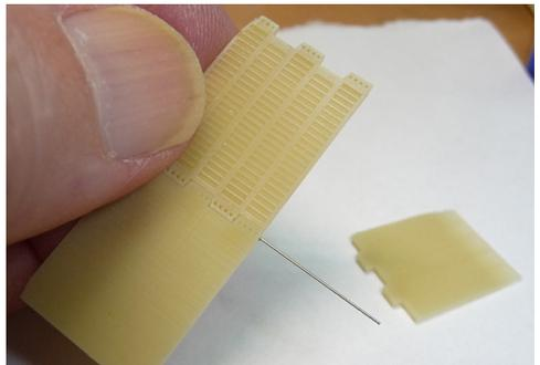
Nachdem die Enden des Achsmaterials abgeschnitten sind, diese mit einem Tröpfchen eines flexiblen Klebers (z.B. Micro Kristal Klear, Art.-Nr.: SFL010) verschließen, um das Herausfallen des Rundmaterials zu verhindern.
