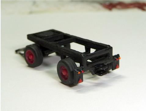
Biegt man sich einen kleinen Winkel aus dem übrigen Stahldraht, lässt sich damit ein Anhängelbolzen für die Klauenkupplung erstellen; entsprechende Löcher sind vorhanden, um auch einen weiteren Hänger fachgerecht an zu koppeln.
