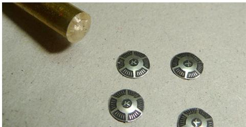
Die Kappen werden in die Vertiefungen der Räder geklebt und die Achsen aus 17-18 mm langen Stücken des beiliegenden 1,0 mm Messing-Rundmaterial gefertigt, durch die Achslager geschoben und die Räder aufgesetzt.
