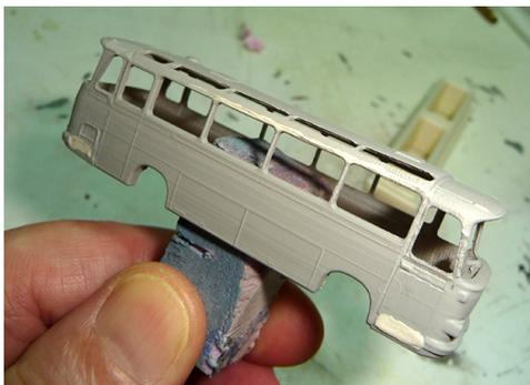
Sobald die Karosserie fehlerfrei ist, erfolgt die endgültige Lackierung und das Aufbringen von Blinkern und Decals für die Beschriftung vorn/hinten und seitlich und – falls gewünscht – der Beschriftung des fiktiven Reiseveranstalters „STUDER-REISEN“.
