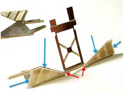
Nach dem passgenauen Zusammenfallen der äußeren Seitenfläche auf den innenliegenden Teil wird durch die Zugabe von ein wenig Lötöl zwischen die aufeinanderliegenden Flächen sichergestellt, dass ein winziger Tropfen Lötzinn beim Anlegen der Lötspitze an die Kante der beiden zusammengefalteten Bleche sofort in den schmalen Spalt dazwischen gezogen wird (Blaue Pfeile).
