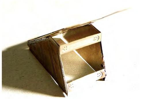
Nun die Querstreben zurechtbiegen und den rückwärtigen Teil des Gleisabschlusses anpassen. Löt-/Klebestellen an den betreffenden Verbindungskanten setzen und zuletzt die Warntafel zusammenfallen.
