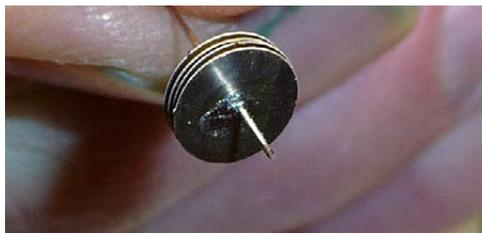
Den Stahldraht überstehen lassen, denn diese Achse wird gleich in den noch zu biegenden Haken eingesteckt.
