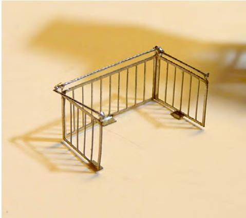
Bevor die drei Laschen in die entsprechenden Ausschnitte der Seitenteile der Plattform eingerastet werden, ist der Handlauf anzubringen.
