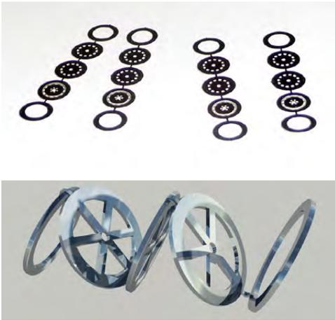
Das können bis zu 10 Schichten sein, die einen Stapel bilden, durch den später ein passender Stahldraht als Achse gesteckt wird.
