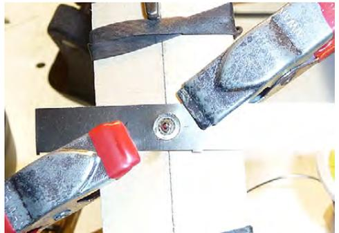
Ein Restblechstreifen bekommt eine Bohrung (zwischen zwei Sperrholzbrettchen bohren!), die etwas kleiner als der Raddurchmesser ist. Mittig wird das Loch des Bleches auf den verlöteten Stapel der Scheiben gelegt und mit zwei Klammern festgeklemmt. Diese Vorrichtung leitet beim Löten der Achse genug Wärme ab, so dass sich die bereits fertigen Lötstellen nicht mehr lösen.
