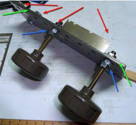
Zwei Holzverbinder-Lochplatten aus dem Baumarkt mit den Maßen  $200 \times 60 \times 2$  mm, die an einer langen Kante schon recht gut aneinanderpassen, werden mit zwei Schrauben an einer der Längsseiten verbunden. Darauf zu achten ist, dass die andere Längsseite etwas auseinanderklafft — hier wollen wir später die zu biegende Kante dazwischenlegen.
