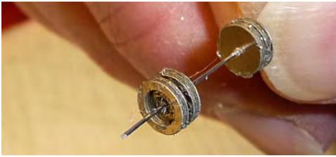
Nach dem Einsetzen der Hinterachse, wird das Blech der Achsaufhängung um die Achse gebogen, fixiert so die Hinterachse und bleibt drehbar.
