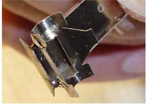
Den Auflager zurechtbiegen wie das folgende Bild zeigt. Die durchgeätzten Kreise werden mit den angeätzten Markierungen des Chassis-Bleches in Übereinstimmung gebracht und befestigt.
