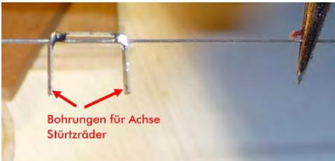
Wer möchte, kann auch die Stützräder drehbar lassen — hier wurden sie verlötet. Die Stahlachse oben wird entsprechend gekürzt und in die Löcher der Chassis-Seitenteile eingesetzt. Jetzt kann der gesamte Bügel mit den Stützrädern in Richtung Heck geklappt werden, wo der Bügel des Sattelauflegers entsprechend zurechtgebogen wird, um die Achse der Stützräder zu
