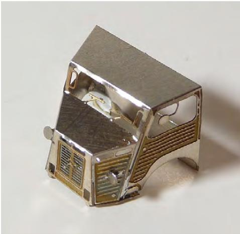
Nach dem Falten und Kleben/Löten der restlichen Seiten des Führerhauses bleiben Seitenspiegel und die Haltegriffe an den Rändern der Windschutzscheibe noch in ihrer ursprünglichen Position. Diese sehr abbrechempfindlichen Teile werden erst nach der Endmontage und dem Lackieren in die endgültigen Positionen gebracht.
