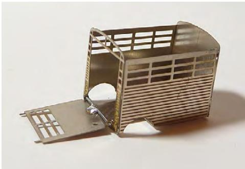
Jetzt kann das Dach befestigt werden. Hier beschrieben wird – wer hätte das gedacht, bei der Vorliebe des Autors zum Löten – die Lötzinnvariante. Nach dem genauen Zurechtbiegen des Daches werden die beiden seitlichen, halb weggeätzten Streifen ins Innere des Aufbaus eingepasst. Dann werden die Kanten zwischen Aufbau und Dach verlötet, ebenso wie die Rundungen an Stirn- und Heckseite. Dabei ist sparsam mit dem Lötzinnauftrag umzugehen!
