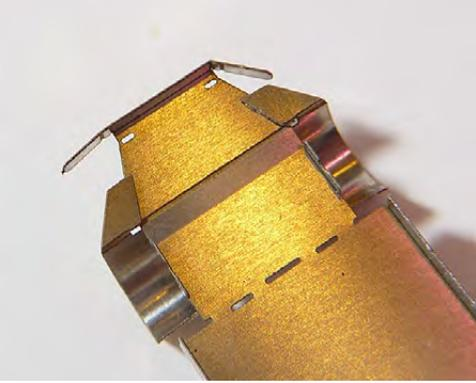
Beim Lötten anschließend die entstehenden Lötunkte wieder so weit wie nötig abfeilen.
