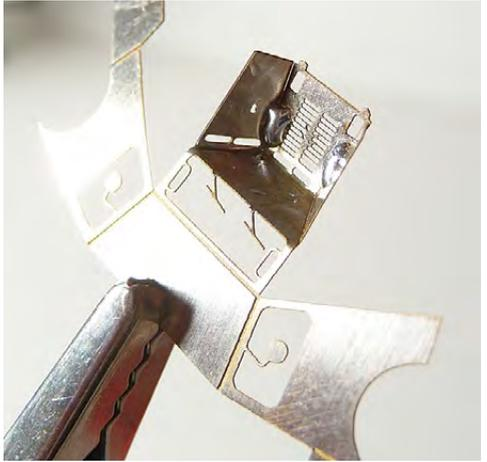
Besonders wichtig ist das Biegen der Kante direkt unterhalb der Scheibenwischer. Diese Kante muss sehr exakt gebogen sein, damit die später angepassten Seitentüren zur Motorhaube hin dicht abschließen.
