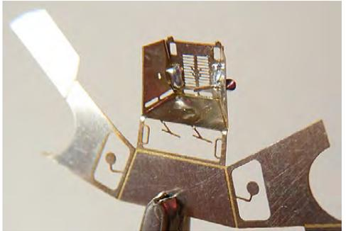
Die Überlänge der Spieße können innen abgewickelt werden. Hier das Bild mit den beiden montierten Scheinwerfern:
