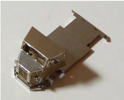
Die beiden Bauelemente aber noch NICHT dauerhaft verbinden! Erst kommt noch die Montage der vorderen Kotflügel.
