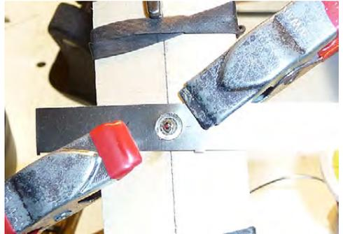
Ein Restblechstreifen bekommt eine Bohrung (zwischen zwei Sperrholzbrettchen bohren!), die etwas kleiner als der Raddurchmesser ist. Mittig wird das Loch des Bleches auf den verlöteten Stapel der Scheiben gelegt und mit zwei Klammern festgeklemmt. Diese Vorrichtung leitet beim Löten der Achse genug Wärme ab, so dass sich die bereits fertigen Lötstellen nicht mehr lösen.
