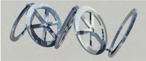
Das können bis zu 10 Schichten sein, die einen Stapel bilden, durch den später ein passender Stahldraht als Achse gesteckt wird.
