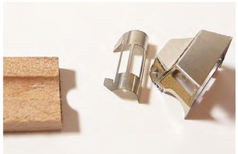
Nachdem die beiden Trittbretter der Kotflügel passend gebogen wurden, werden diese von unten am Boden des Chassis eingepasst und verlötet/verklebt:
