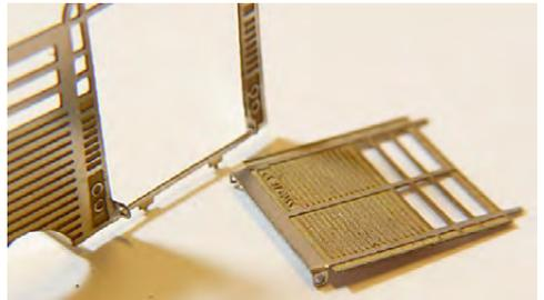
Anschließend werden die verzinnten Kanten sowie die Längsknicke im Dach verschliffen:
