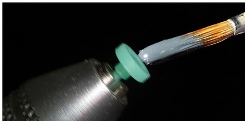
Zuerst insgesamt in Felgenreife lackieren, dann – wie ausführlich im PDF-Dokument „Hinweise zum 3D-Druck.pdf“ beschrieben (liegt Ihrer Auftragsbestätigung als eMail-Anhang bei oder zu finden auf der **etchIT**-Website unter „Bauanleitungen“) – mit Hilfe eines Akkuschraubers sauber runde Reifen aufmalen:
