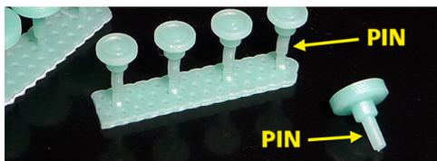
Dieser wird in eine Akkubohrmaschine mit langsamer Drehzahl als Hilfsachse beim Lackieren eingespannt.
