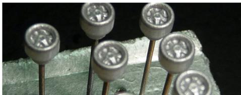
... dann – wie ausführlich im PDF-Dokument „Hinweise zum 3D-Druck.pdf“ beschrieben (liegt Ihrer Auftragsbestätigung als eMail-Anhang bei oder zu finden auf der **etchIT**-Website unter „Bauanleitungen“) – mit Hilfe eines Akkuschraubers sauber runde Reifen aufmalen:
